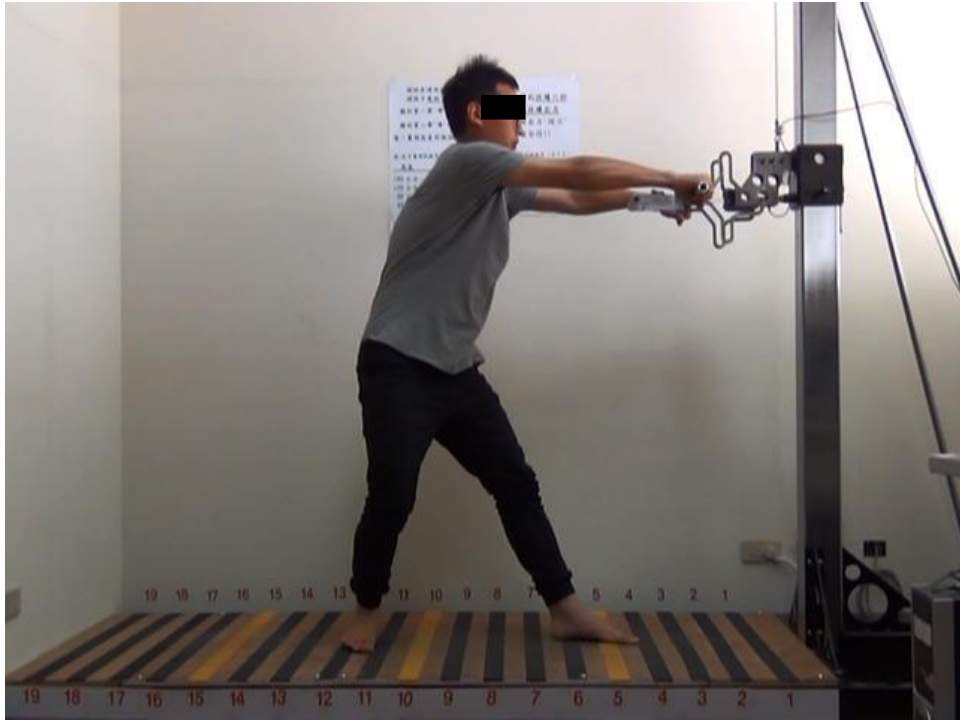
(a) 男性受測者在高度 120cm 處的雙手拉力量測
