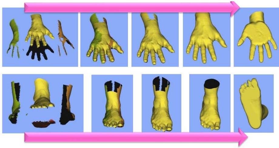
圖 19 將 4 片資料整合為一隻完整的 3D 手型（腳）資料
