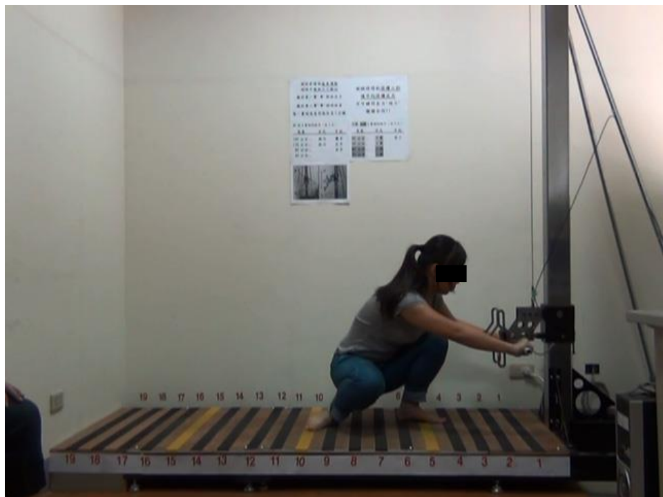
(b) 女性受測者在高度 40cm 處的雙手推力量測
