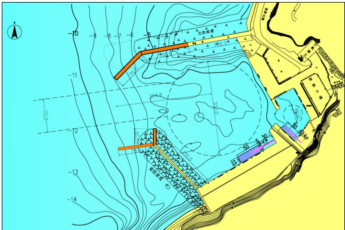
圖 6.1-6 北竿白沙碼頭區外廓防波堤及航道研擬配置圖
